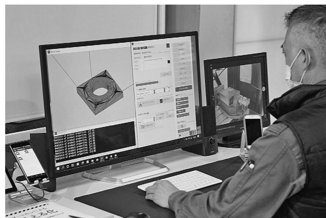
アルムコード1で自動生成された加工プログラム
